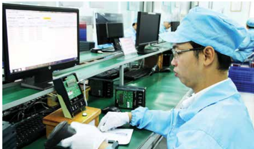
Mỗi công đoạn trong dây chuyền sản xuất các sản phẩm công tơ điện tử “made in EVNCPC” đều được kiểm soát chặt chẽ
