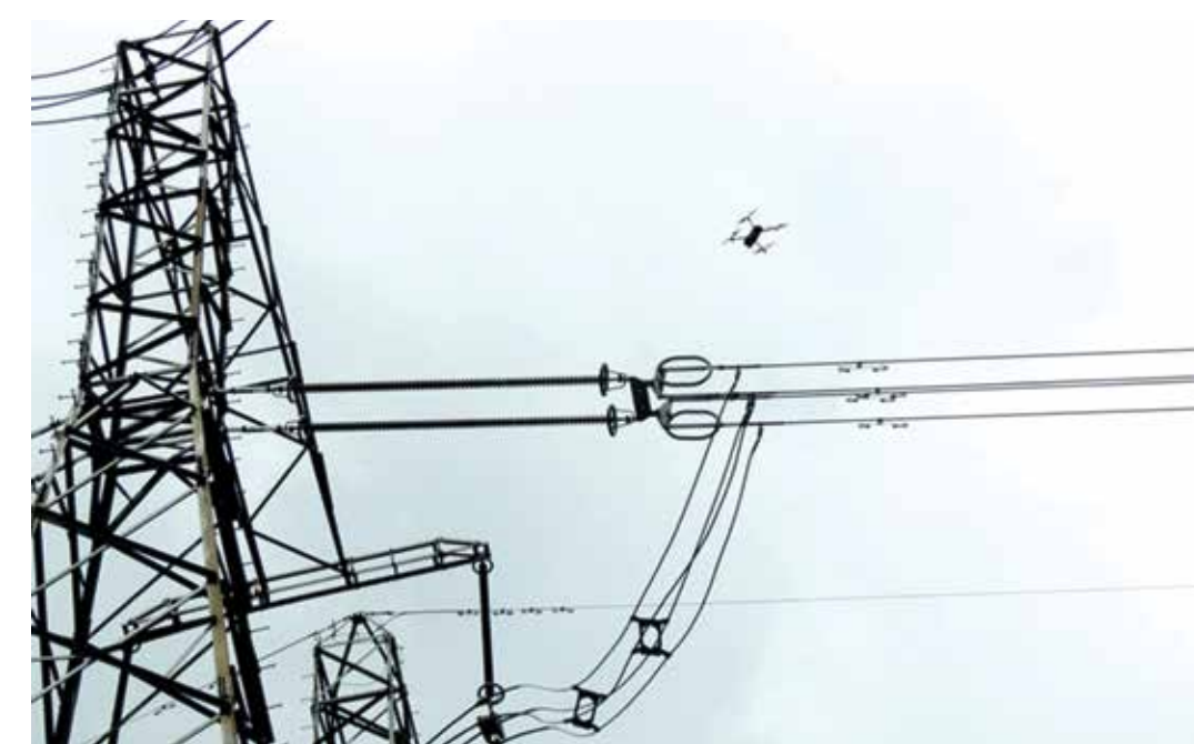
Sử dụng UAV và Flycam để kiểm tra thiết bị trên đường dây.
